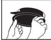
Insérez la manchette dans le trou en la tournant dans le sens inverse des aiguilles d'une montre.
