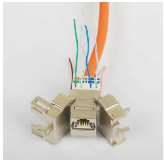
4. Emboîter fermement le couvercle de maintien sur le connecteur afin d'enfoncer complètement les fils dans les interstices.
