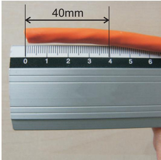
1. Dégainer le câble RJ45 CAT6 sur 40 mm minimum.
